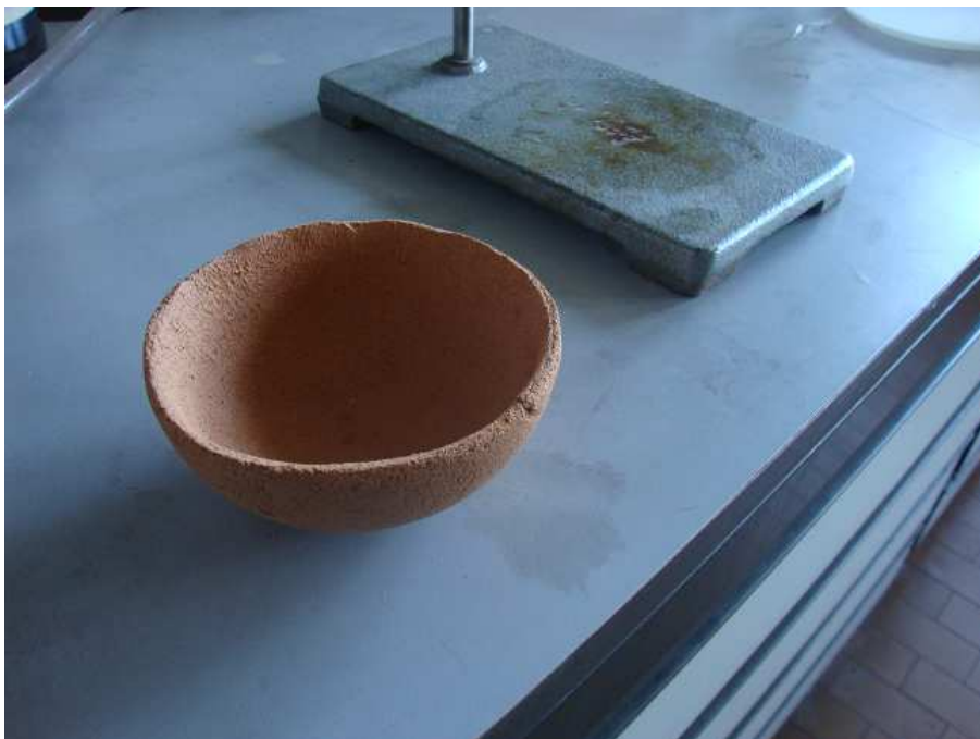
Fig.2. Ciotola di terracotta per la filtrazione dell'acqua
