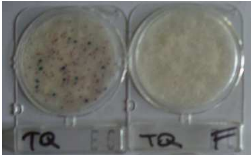
Fig.3 Colonie di batteri nell'acqua di pozzanghera prima (sinistra)e dopo (destra) la filtrazione su terracotta
