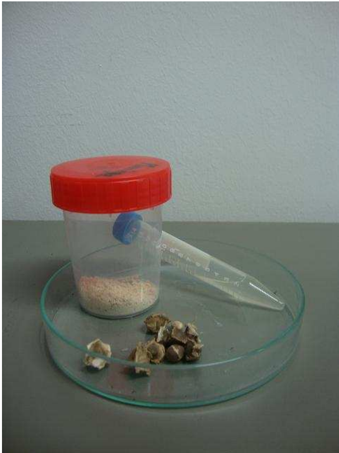
Fig. 1 kit per potabilizzare l'acqua. Semi di Moringa , semi macinati, estratto acquoso.
